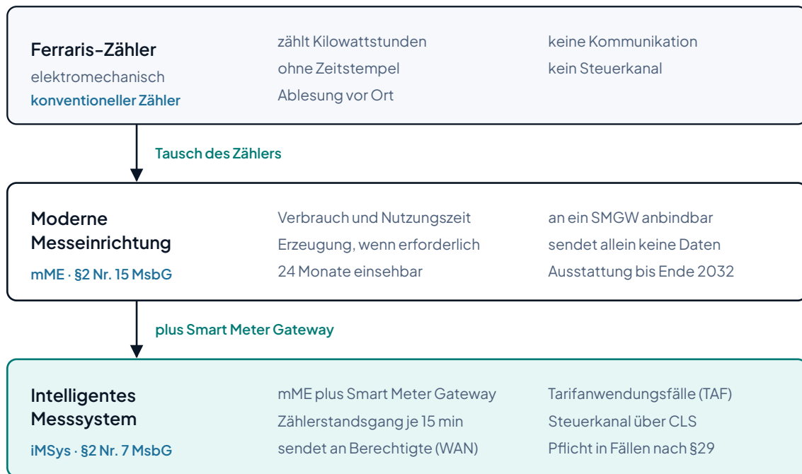
Abbildung 1: Drei Stufen der Messtechnik. Der Ferraris-Zähler zählt Kilowattstunden ohne Zeitbezug, die moderne Messeinrichtung erfasst Verbrauch und Nutzungszeit und kann angebunden werden, erst das Smart Meter Gateway macht daraus ein intelligentes Messsystem mit Fernübertragung und Steuerkanal. Viertelstundenwerte liefert es, sobald der Zählerstandsgang nach TAF 7 eingerichtet ist.
